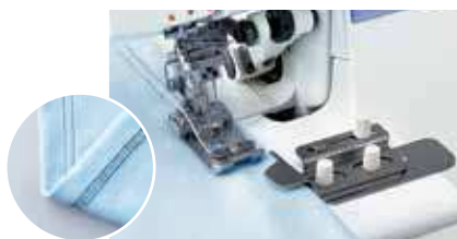
9 Vodítko na krycí steh Na rovné vedenie lemovacích švov.
