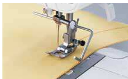
26 Vodítko Na udržanie rovnakých vzdialeností medzi švíkmi.
