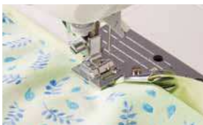
14 Spojovacia päťka Na spájanie páskou do záhybov
