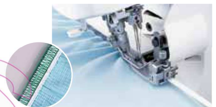
3 Pätko - elastikátor (prišívanie elastickej pásky)
