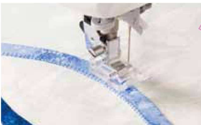
22 Päťka na aplikácie Naprišivanie aplikácií. (predná a zadná časť sú kratšie pre ľahké otáčanie šitého materiálu).
